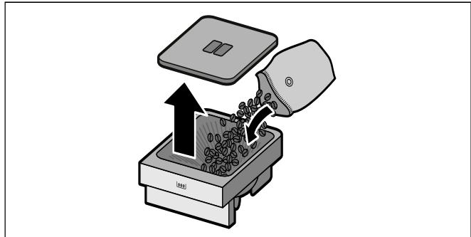
**Указание:** Глазированные, карамелизованные или обработанные другими содержащими сахар добавками кофейные зерна приводят к забивке заварочного блока. Используйте только смеси кофейных зерен, предназначенные для полностью автоматической кофемашины.
