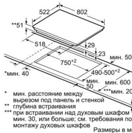
\* мин. расстояние между вырезом под панель и стенкой
