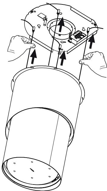
**Poner en tensión los cables empujándolos hacia lo alto de manera que se desplacen dentro del tornillo bloqueacable y fuera del ojal del pasador roscado.**
