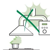
Conecte la campana extractora al conducto de humo a través de un tubo con un diámetro mínimo de 120 mm. La trayectoria del humo debe ser lo más corta posible.
