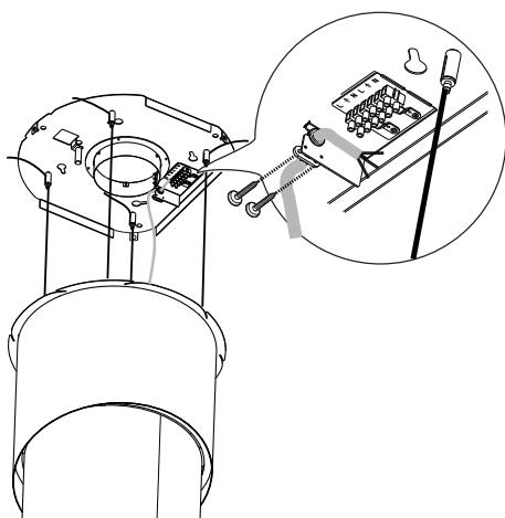
Проверьте крепление кабеля питания; при движении к потолку подвижной части корпуса вытяжки кабель должен оказываться над ней и не должен выходить за габариты прибора.
