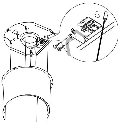
Vérifier enfin que le câble d'alimentation est correctement bloqué, en contrôlant que lorsque le corps mobile se soulève vers le plafond, celui-ci se positionne au-dessus du corps mobile et qu'il ne sort pas du pourtour de la hotte.
