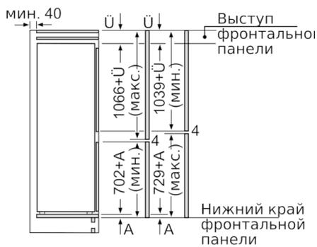
Размеры приведены с учетом зазора между дверцами 4 мм.
