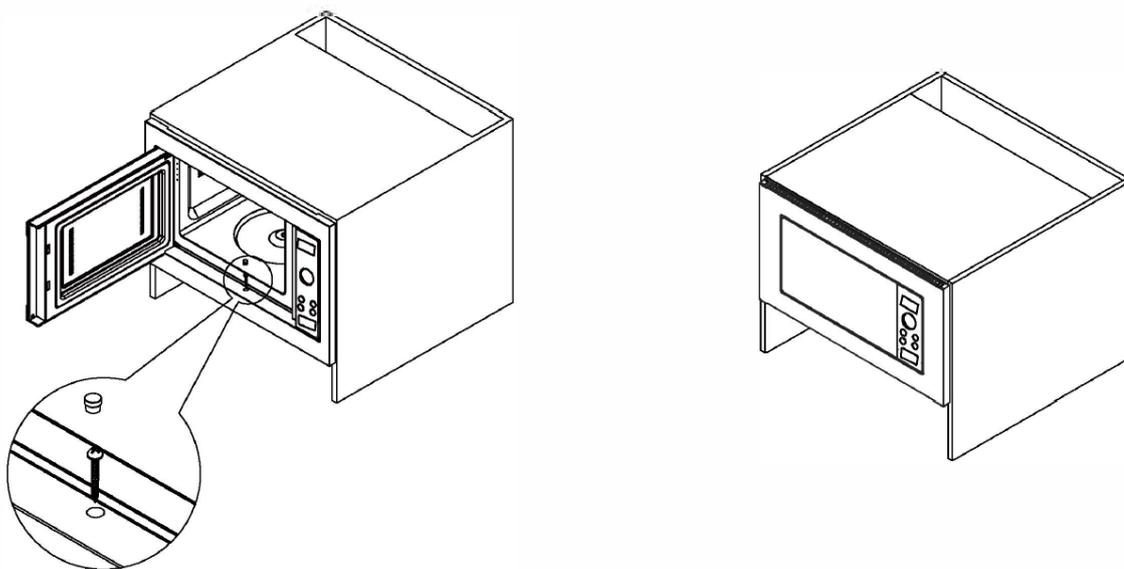
2. Откройте микроволновую печь, закрепите болт (компонент 3) и прикрутите его к корпусу, затем установите винтовую крышку.
