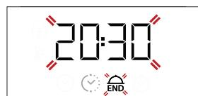
Pomocou alebo nastavte želaný čas ukončenia pečenia a stlačte na potvrdenie. Funkciu aktivujete otočením gombíka termostatu na požadovanú teplotu. Funkcia zostane pozastavená, až kým sa nespustí automaticky po uplynutí času vypočítaného tak, aby sa príprava jedla ukončila v čase, ktorý ste nastavili.
