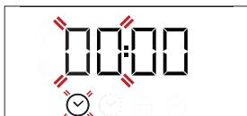
Saat ayarlamak için ☓ veya ☔'i kullanın ve onaylamak için ☺'e basın. Dakikaya ait iki rakam yanıp sönmeye başlayacaktır. Dakikayı ayarlamak için ☓ veya ☔'i kullanın ve onaylamak için ☺'e basın.
