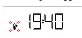
يرجى ملاحظة: إنشاء عملية الطهي يمكنك تغيير الوظيفة عن طريق إدارة مفتاح الاختيار أو ضبط درجة الحرارة بإدارة مفتاح الترمومسّنات. لا تبدأ الوظيفة في التشغيل إلا عندما يكون مفتاح الترمومسّنات عند درجة 0 °م. ويمكنك ضبط مدة الطهي، وقت انتهاء الطهي (فقط عند ضبط مدة الطهي) وكذلك الميقاتي.
