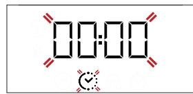
Pomocou alebo nastavte požadovanú dobu pečenia a potom stlačte na potvrdenie. Funkciu aktivujete otočením gombíka termostatu na požadovanú teplotu. Ozve sa zvukový signál a na displeji sa zobrazí, že pečenie je ukončené.
