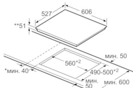
\* мин. расстояние между вырезом под панель и стенкой
