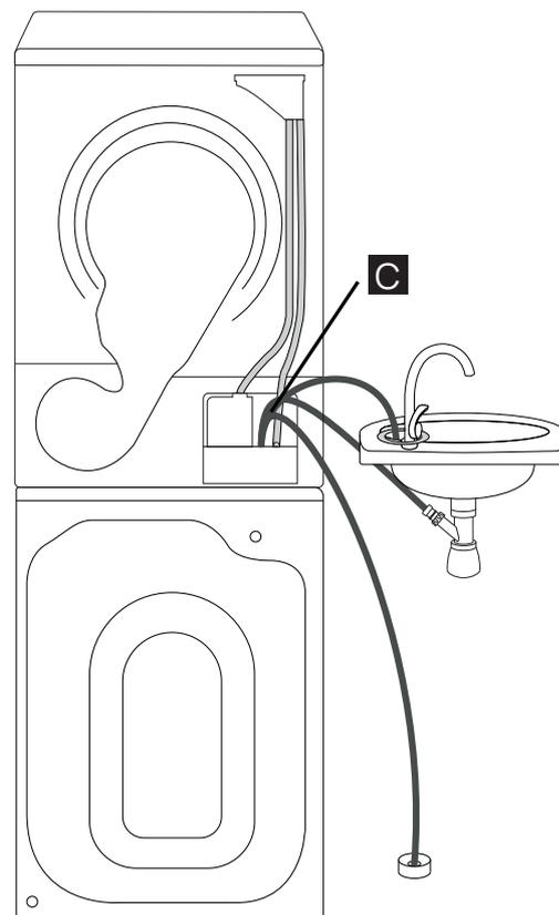
Установка сушильной машины в колонну
