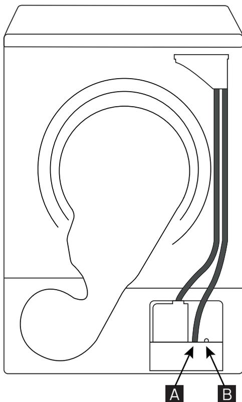
Подключение дренажного шланга к сушильной машине
