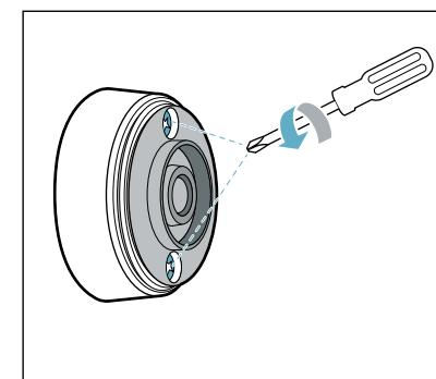
2. Откройте заглушку датчика температуры. Выньте батарейку из нижней части корпуса и установите новую батарейку (при этом следите за правильной установкой полюсных выводов батарейки).
