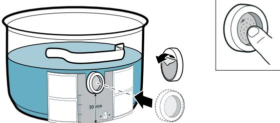
3. Прижать всю поверхность силиконовой накладки, также и изнутри.
