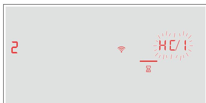
5. Зарегистрируйте мобильное устройство в сети варочной панели при помощи SSID «HomeConnect» с Key «HomeConnect».
