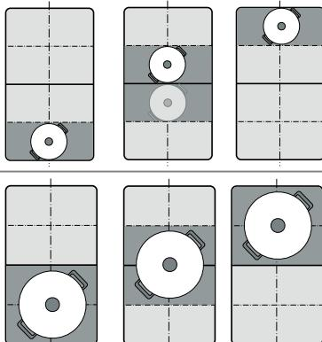
Таким образом, посуда в ходе приготовления может быть перемещена на другую варочную поверхность с другой ступенью нагрева:
