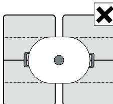
Устанавливайте посуду на варочных панелях с более чем одной свободной зоной нагрева таким образом, чтобы была покрыта только одна из свободных зон нагрева.
