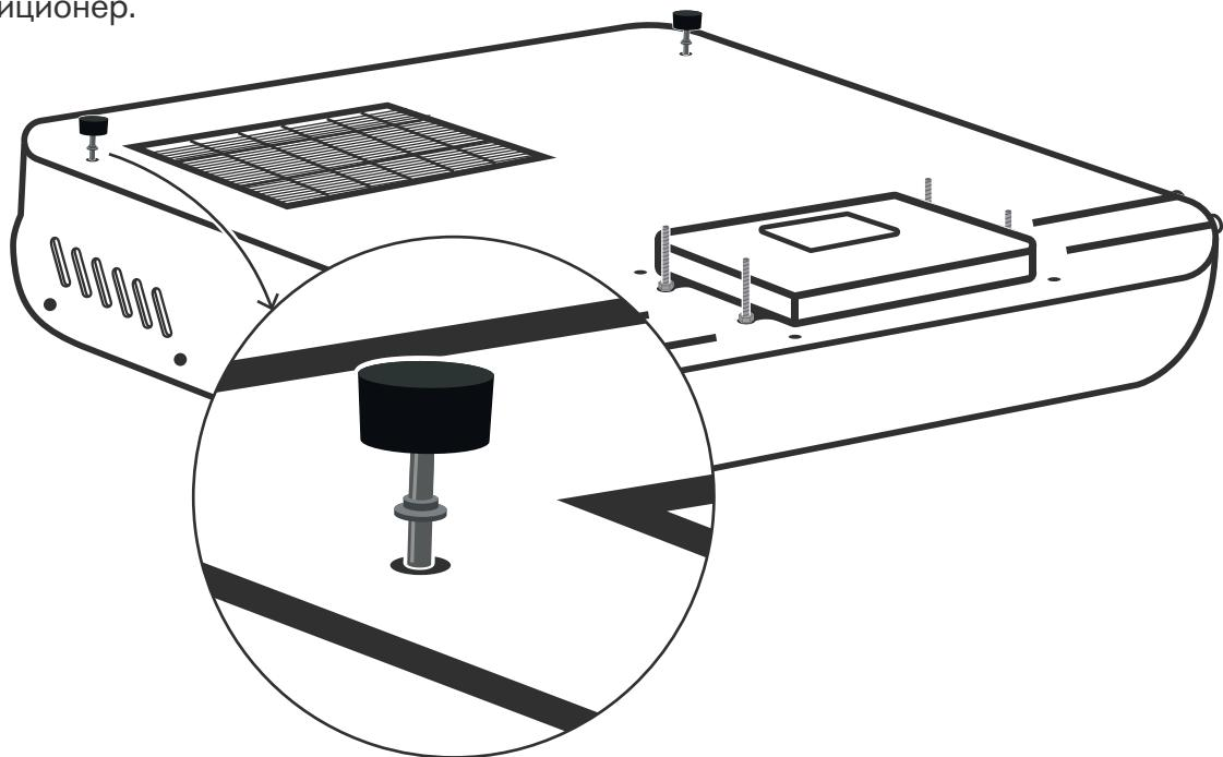
Примерьте кондиционер в люк, шпильки должны находиться внутри люка, отрегулируйте ножки по высоте и зафиксируйте гайкой, чтобы кондиционер не провисал назад.
