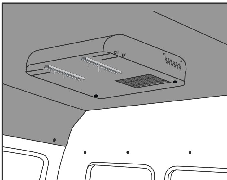
7. Установите прижимные планки и зафиксируйте их гайками.
