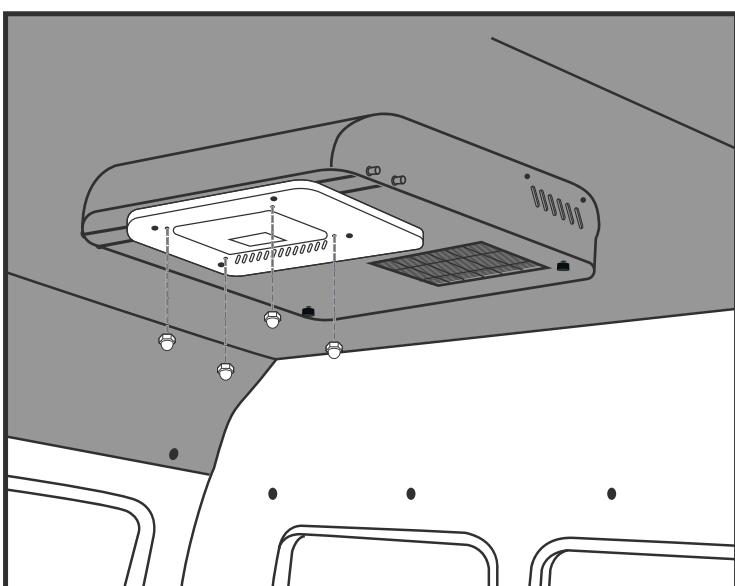
11. Зафиксируйте гайками пластиковую панель.
