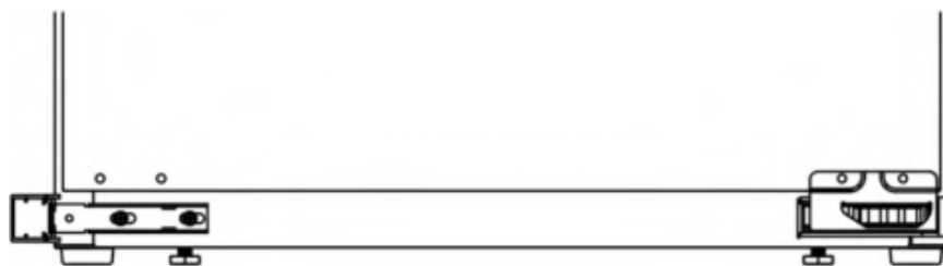
Схема установки крепежа и крышки крепежа снизу
